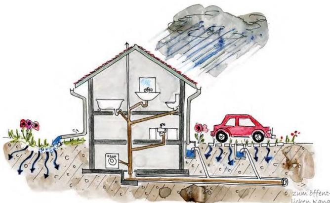
Oberägeri hat ein Abwasser-Trennsystem. Im Trennsystem fliesst das saubere Regenabwasser getrennt vom Schmutzwasser, in einer separaten Leitung in das nächste Gewässer oder wird zur Versickerung gebracht.
