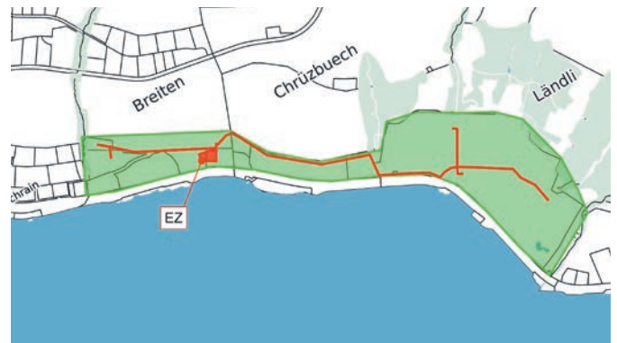
Abbildung 3: Versorgungsperimeter und möglicher Standort für eine Energiezentrale inkl. Netz – Energieverbund Breiten/Ländli
